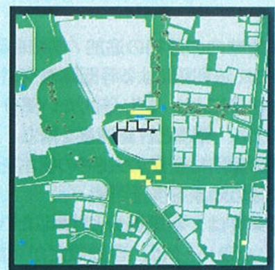
対象街区の風環境影響評価結果 地上1.5m (左:計画建物建設前 中:同建設後 右:建設前後の風環境評価結果の変化)
